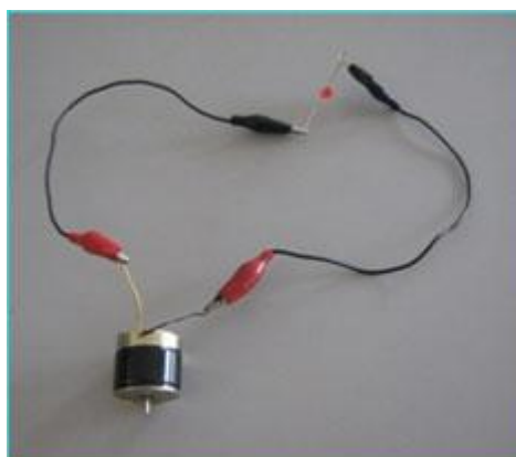
Figura 4.1 – Montagem do motor elétrico e o LED
