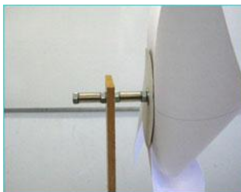
Figura 5.2 – Montagem do cata-vento no suporte
