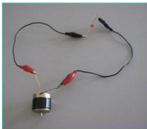
Figura 4.1 – Montagem do motor elétrico e o LED
