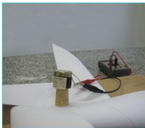
Figura 6.2 – Conexão dos terminais do motor com o multímetro
