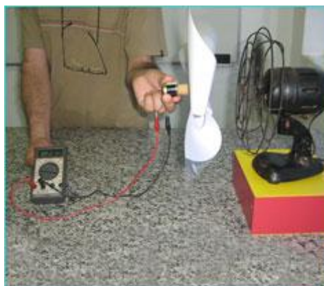
Figura 6.3 – Disposição do cata-vento e ventilador
