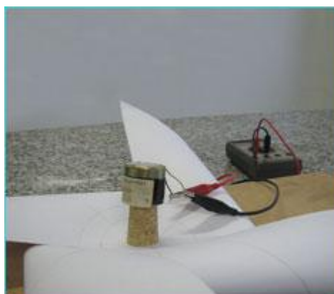
Figura 6.2 – Conexão dos terminais do motor com o multímetro
