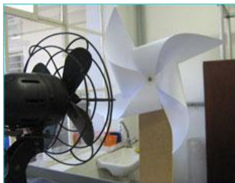
Figura 5.5 – Posição do ventilador em frente ao cata-vento
