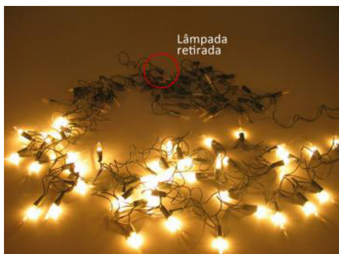
Conjunto de lâmpadas apagadas pela retirada de uma delas.
