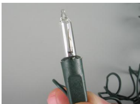
Lâmpada com lâmina bimetálica.
