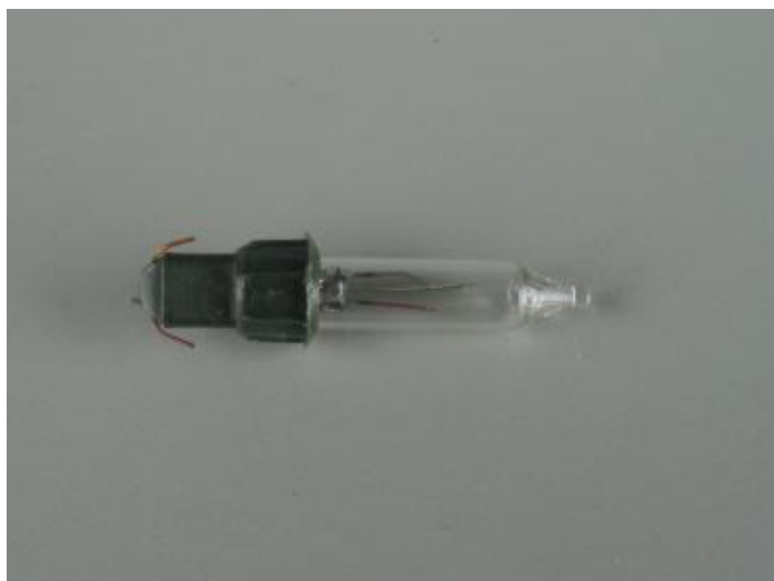
Lâmpada com lâmina bimetálica para ser recolocada no circuito.
