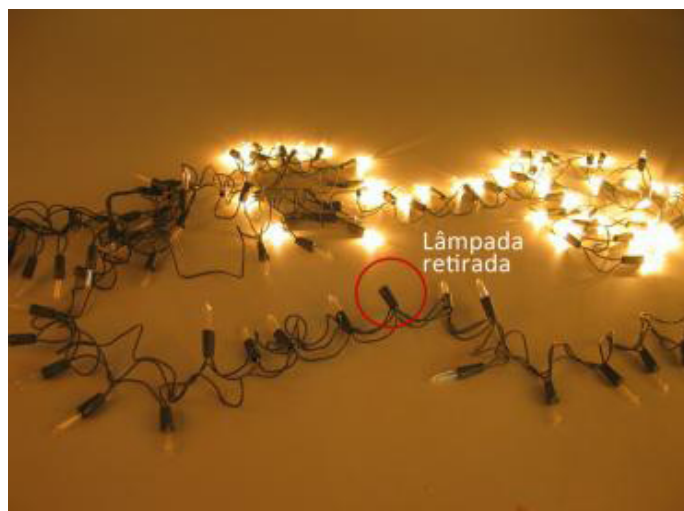
Conjunto de lâmpadas apagadas devido a retirada de uma delas.
