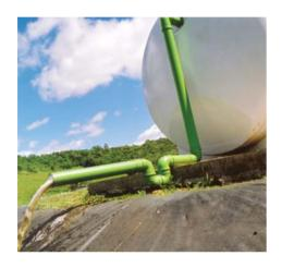
A água liberada pelo sistema Mizumo tem eficiência de 90% a 96% na remoção de DBO. Pode ser reutilizada para outros fins não potáveis, além da irrigação de plantações, como lavagem de automóveis, jardins, pisos e paredes e também em sistemas de resfriamentos e arrefecimento.
