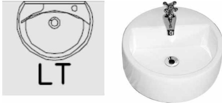
À esquerda temos a representação de um lavatório. À direita uma foto de um lavatório.
