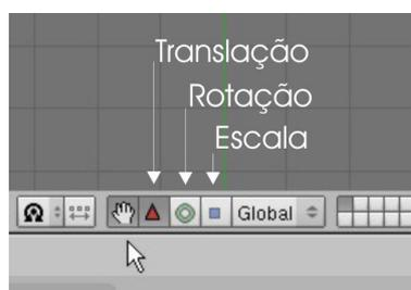
Fig. 4.2: Botões de edição na barra do cabeçalho.
