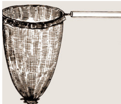
Figura 19b - O cabide funcionará como armação para a rede, sendo este fixado ao cabo de vassoura com auxílio de fita isolante ou arame.
