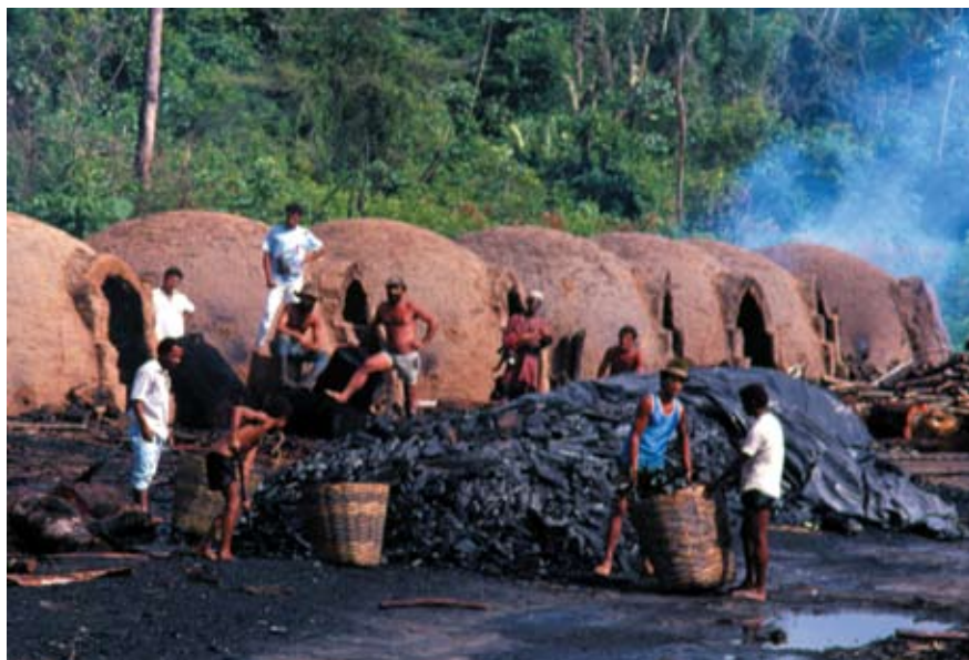
Fornos de barro usados na transformação da lenha em carvão vegetal.
