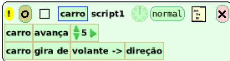
Quando o script estiver criado, você está pronto para dirigir o carro. Na categoria básico, coloque o valor 0 para "direção" do volante. Inicie o script e rapidamente traga os manipuladores do volante. Mantenha o mouse premido no manipulador "rotação" azul e comece a dirigir o carro.
