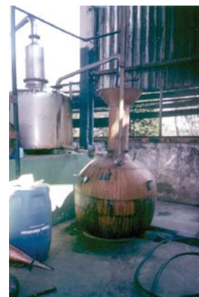
Alambiques de cobre utilizados para destilar a cachaça
