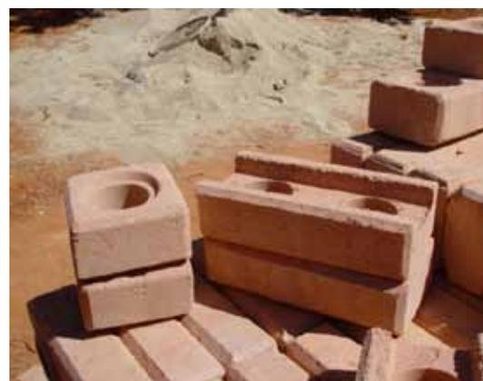
Esse tipo de bloco prensado não precisa de revestimento e praticamente dispensa argamassa de assentamento.
