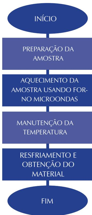
Um fluxograma de obtenção de materiais cerâmicos por intermédio de um forno microondas é ilustrado na Figura 1
