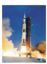
Um foguetão espacial possui uma grande quantidade de energia química (no combustível) pronta a ser utilizada enquanto espera na rampa. Quando o combustível é queimado, esta energia é transformada em calor, uma forma de energia cinética. Os gases de escape produzidos impelem o foguetão para cima.
