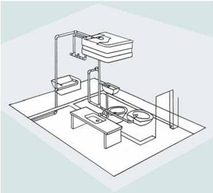
A figura ao lado mostra o desenho esquemático das instalações hidráulicas em uma edificação, desde o traçado das tubulações até os pontos de consumo. A água vem da rede de abastecimento e é armazenada na caixa d'água. Da caixa d'água ela desce para os pontos de consumo sempre que solicitada, através do acionamento das descargas, registros ou torneiras.
