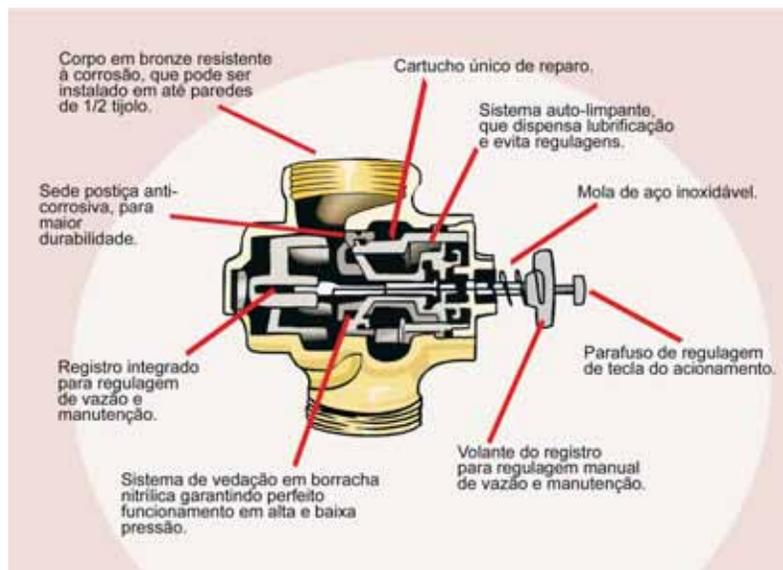
ela é mais indicada para uso público devido a sua inviolabilidade e maior vida útil dos seus componentes. A figura a seguir mostra internamente o sistema de funcionamento de uma válvula de descarga.
