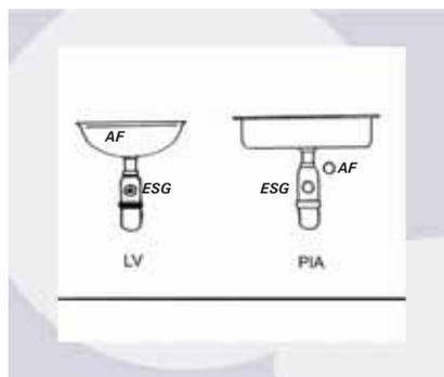
LV (lavatório banheiro) - AF (água fria): 60 cm e ESG (esgoto): 58 cm
