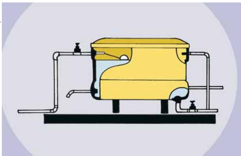
O volume total de água a ser armazenado no reservatório deve ser, no mínimo, o necessário para 24 horas de consumo normal no edifício e no máximo, 3 vezes o consumo estimado. A capacidade dos reservatórios deve ser estabelecida levando-se em consideração o padrão de consumo de água no edifício, a freqüência e duração de interrupções do abastecimento.
