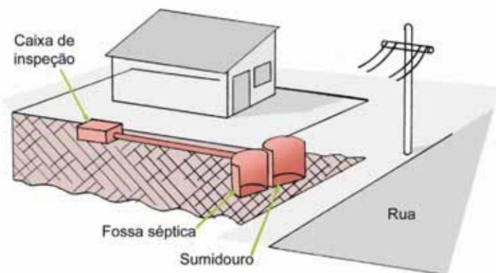
É usual construir dois poços para o lançamento do esgoto: um denominado **fossa séptica** e o outro sumidouro (conforme desenho). O primeiro funciona como um decantador (separador de sedimentos) e o segundo como absorvente, facilitando muito a infiltração de água, dando uma maior vida útil ao sistema. O primeiro absorve poucos sólidos, diminuindo a colmatação (impermeabilização das paredes) do segundo poço. O sumidouro deve ter pequena profundidade para não atingir o lençol freático.
