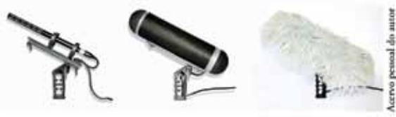
MICROFONE SHOTGUN DESPROTEGIDO, COM ZEPPELIN E COM PELÚCIA, PARA ELIMINAÇÃO DO RUÍDO DE VENTO.
