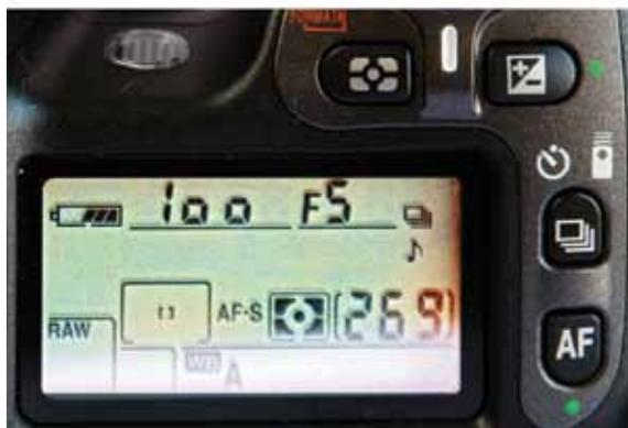
FIGURA 5 - DISPLAY DE UMA CÂMERA DIGITAL INDICANDO TEMPO DE EXPOSIÇÃO E ABERTURA DE DIAFRAGMA.
