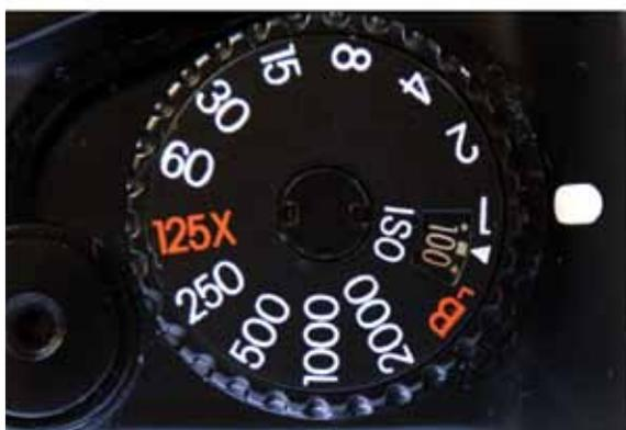
FIGURA 1 - ANEL DE REGULAGEM INDICANDO O ISO DO FILME E A VELOCIDADE DE OBTURAÇÃO.
