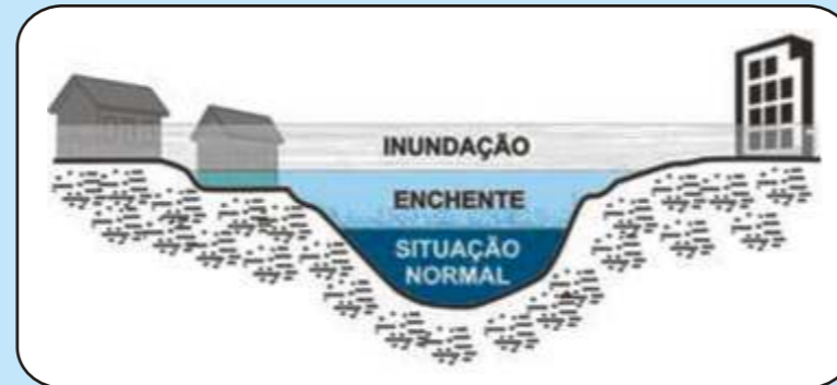
Perfil esquemático do processo de enchente e inundação
